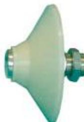
Les fluidiseurs VBM, VBE et VB provoquent un effet de fluidification et de vibration contre les parois de silos. L'air comprimé est introduit dans le matériau directement à travers la lèvre qui adhère à la paroi interne du silo. Pour poudres et granulaires.
