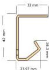
Profil de fixation à décrochage rapide en galva ou inox, décrochage rapide des lanières.
